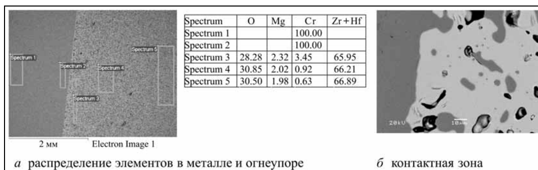
Рис. 7. Контактное взаимодействие огнеупора с хромом: а) распределение элементов в металле и огнеупоре; б) контактная зона
